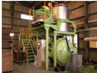
減圧加圧装置
